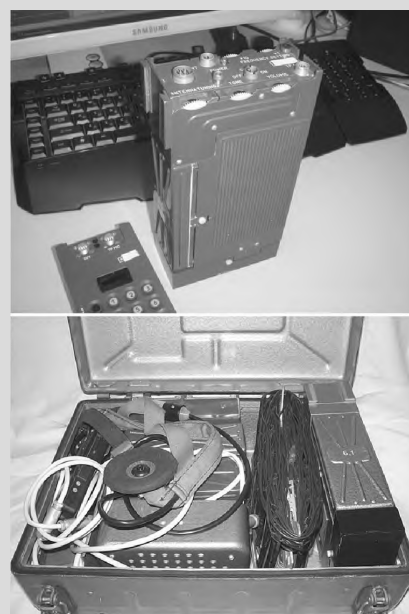
Радиостанция «Северок-К», клавиатура дает представление о размерах
