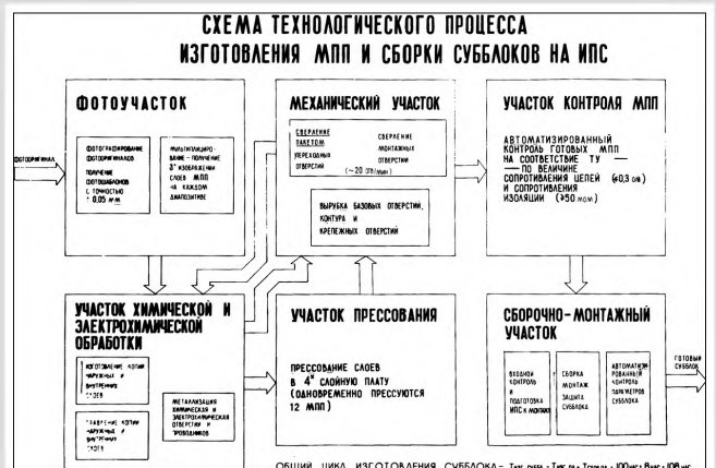
Схема технологического процесса изготовления МПП и сборки субблоков на ИПС
