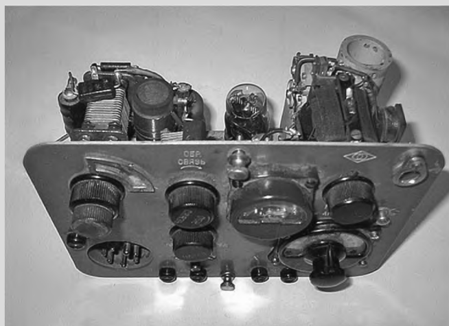
Внутреннее устройство радиостанции «Север». На правой нижней фотографии виден разъем для подключения кварцевого резонатора
