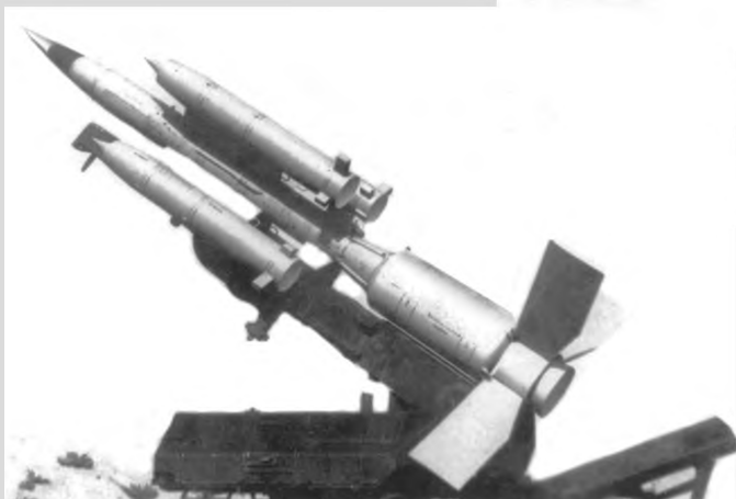
Ракета 22Д (предназначена для поражения цели на дальности до 60 км, высотах до 35 км, летящей со скоростью до 3000 км/час)
