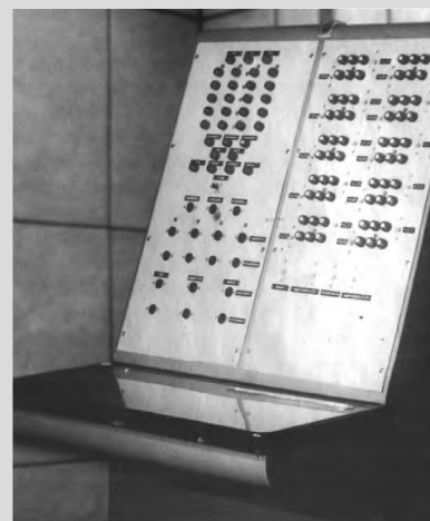
Пульт управления старшего оператора станции Б-200
